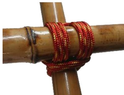
Le brêlage permet d'assembler 2 morceaux de bois perpendiculairement ou avec un certain angle.
